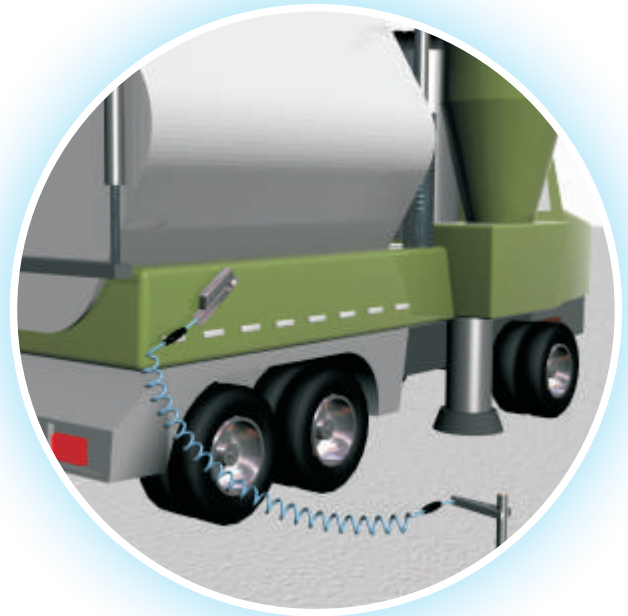
Conexión equipotencial de un camión cisterna aspirante a una pica de tierra
