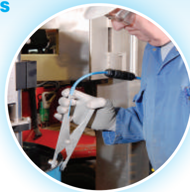
Pince universelle de mise à la terre et raccord Quick Connect inclus
